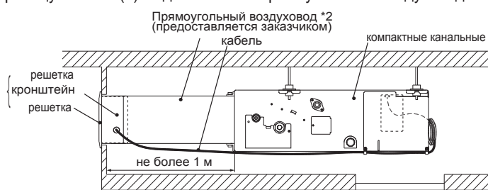
(б) Подключение с прямоугольным воздуховодом
