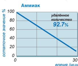
Испытательный метод: JEM 1467 помещение: 1м3, ящик с акриловым герметиком. Условие измерений: сигаретный дым (5 одновременно горящих сигарет)
