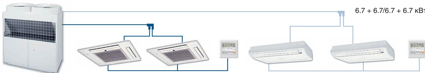
Используется для кондиционирования двух разделенных помещений площадью порядка 500 м<sup>2</sup> (125 м<sup>2</sup>+125 м<sup>2</sup>)
