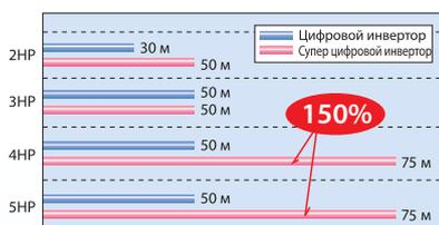
Длина трассы может достигать 75 м, а перепад высот между наружным и внутренним блоком – 30 м. Самые сложные проблемы монтажа решаются проще, если вы устанавливаете наружный блок Super Digital Inverter 4!
