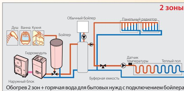
Если здание уже оборудовано обычным бойлером на газовом или твердом топливе, то тепловой насос с передачей тепла от воздуха к воде **Toshiba Estia может быть объединен с существующей системой отопления**. В результате Вам круглогодично обеспечен оптимальный нагрев воды. Бойлер будет использоваться только как резервный источник нагрева в особенно холодные зимние дни.
