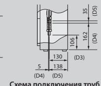
Схема подключения труб
