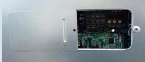
**Крышка легко сдвигается в сторону и открывает доступ к плате управления. Теперь не нужно снимать панель с наружного блока.** Эта особенность SMMS-i обеспечила удобный доступ к инверторной плате для обслуживания, адресации, тестового пуска и т.п.
