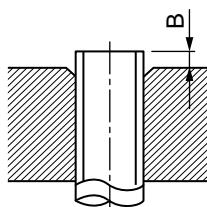
Если для развалицовки труб, которые будут использоваться с R410A, Вы применяете обычные инструменты, растрюй должен быть примерно на 0,5 мм длиннее, чем для R22. Для регулировки диаметра растрюба удобно использовать измеритель, специально предназначенный для медных трубок.
