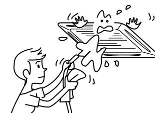
**Проверяйте, в хорошем ли состоянии крепежная панель, крепления и др.** В результате ухудшения состояния здания в целом крепления блоков кондиционера могут ослабнуть, блоки могут упасть и причинить ущерб.
