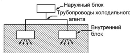
(3) Если в каждом отделенном перегородками помещении устанавливается внутренний блок, а трубопроводы холодильного агента соединены между собой, то предметом рассмотрения становится помещение самого малого объема. Но если монтируется система принудительной вентиляции с детектором утечки в помещении самого малого объема, в котором превышается допустимая плотность, то предметом рассмотрения становится объем следующего по величине помещения.
