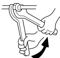
Затягивайте гайки двумя гаечными ключами
