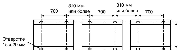
2. Если трубы холодильного контура подключаются к блоку снизу, высота подставки под блоком должна составлять не менее 500 мм.
