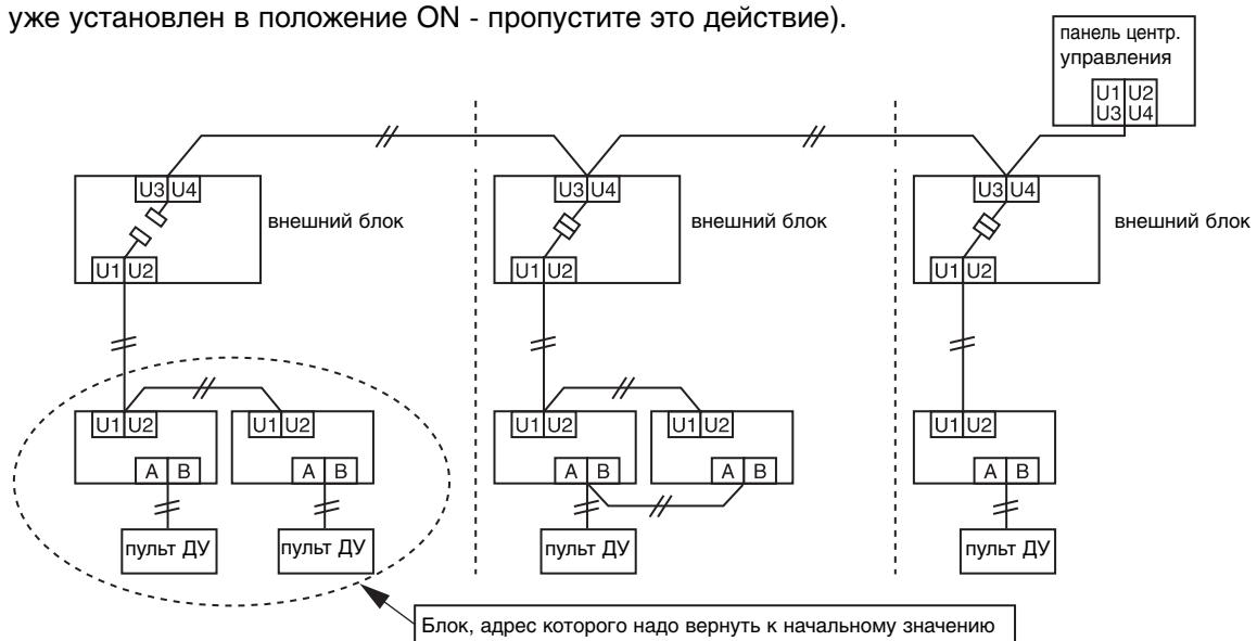
2. Включите электропитание блока, адрес которого Вы хотите изменить. Примерно через 1 минуту на дисплее появится “**U.1.---**”. После этого выполните действия, описанные ниже, на интерфейсной плате внешнего блока, адрес которого Вы хотите удалить.
