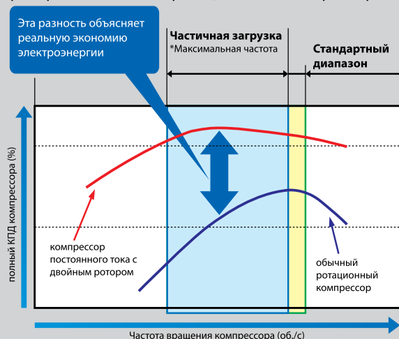
Сравнение компрессора постоянного тока с двойным ротором и обычного ротационного компрессора
