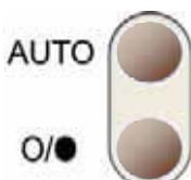
«Auto» – Переключение между ручным и автоматическим режимом терморегуляции.
