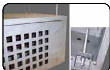
Зафиксировать стержни контргайками M10 с обеих сторон кронштейна (контргайки и резьбовые стержни в комплект не входят). Необходимо убедиться, что стержни не выступают с нижней части агрегата. Следует обеспечить надежность крепления резьбовой шпильки на соответствующей конструкции, которая способна выдержать вес блока (ссылка на данные веса приведена в Таблице 2).
