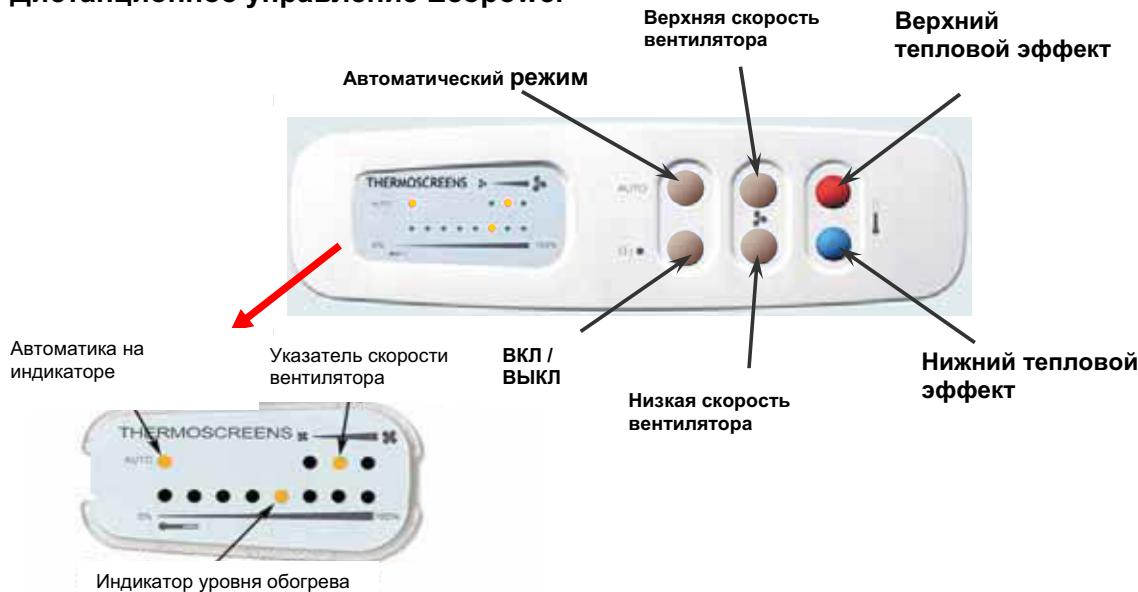
**Нажмите кнопку ВКЛ/ВЫКЛ для включения, затем:-**
