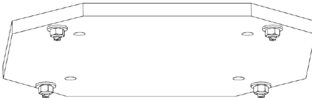
На рисунке показан пример крепления центральной пластины к перекрытию при помощи анкерных дюбелей.
