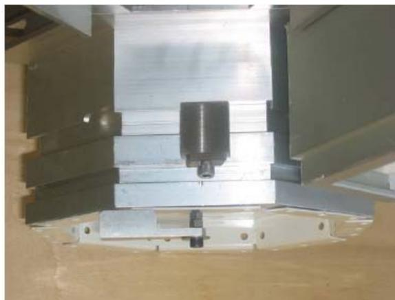
Возьмите фильтр, не касаясь системы защиты от неисправностей. Поднимите фильтр с сальником к верхней стороне на участке между двумя профилями, как показано на рисунке.
