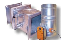
Огнезадерживающие клапаны Systemair изготовлены и сертифицированы согласно последних Европейских стандартов EN1366-2. Systemair предлагает широкий ассортимент клапанов разных размеров и с разным пределом огнестойкости: 60, 90 и 120 мин. для круглых каналов и 90 и 120 мин. для прямоугольных каналов. PK-I-R: от ø100 мм до ø1000 мм PK-I-S: от 100x100 мм до 1600x1000 мм
