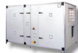
Воздухообрабатывающие установки (АНУ) DV состоят из модулей, что позволяет создавать различные конфигурации, как отдельных приточно-вытяжных воздухообрабатывающих агрегатов, так и полноценных систем с утилизацией тепла. Существует 12 типоразмеров DV с расходом воздуха от 1500 м³/ч до 85 000 м³/ч, благодаря чему вы можете легко подобрать подходящий агрегат.
