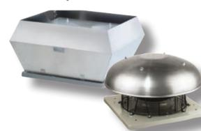
Вентиляторы DVS/DHS оснащены рабочим колесом с лопатками, загнутыми назад и двигателем с выносным ротором. Корпус выполнен из стойкого к воздействию морской воды алюминия. Рама изготовлена из оцинкованной стали с защитным порошковым покрытием. Вентиляторы DVSI имеют слой звукоизоляции толщиной 50 мм.
