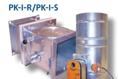
Огнезадерживающие клапаны Systemair изготовлены и сертифицированы согласно последних Европейских стандартов EN1366-2. Systemair предлагает широкий ассортимент клапанов разных размеров и с разным пределом огнестойкости: 60, 90 и 120 мин. для круглых каналов и 90 и 120 мин. для прямоугольных каналов. PK-I-R: от Ø100 мм до Ø1000 мм PK-I-S: от 100x100 мм до 1600x1000 мм PK-I-S: 100x100 mm to 1600x1000 mm
