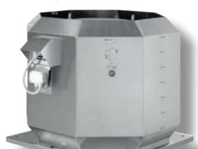
Крышный вентилятор дымоудаления с лопастями загнутыми назад. Подходит для двух режимов работы (нормальная и противопожарная вентиляция). Максимальный расход: 55 000 м<sup>3</sup>/ч. Предел огнестойкости 400°C/120 мин 600°C/120 мин.
