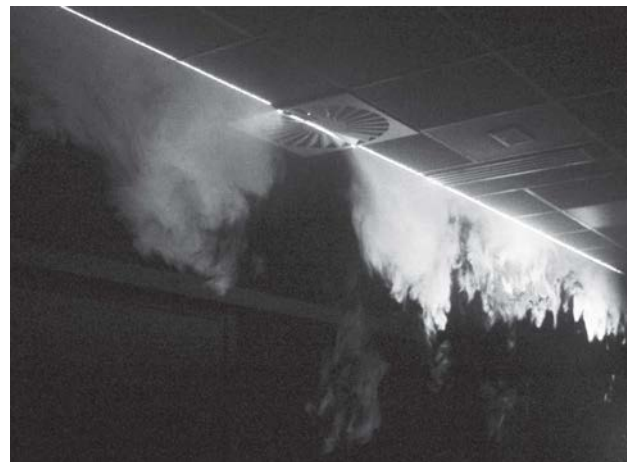
Fig. 1: Isothermal air flow visualisation
