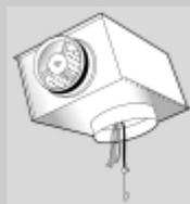
Измерьте настройки давления с помощью двух прозрачных трубок.
