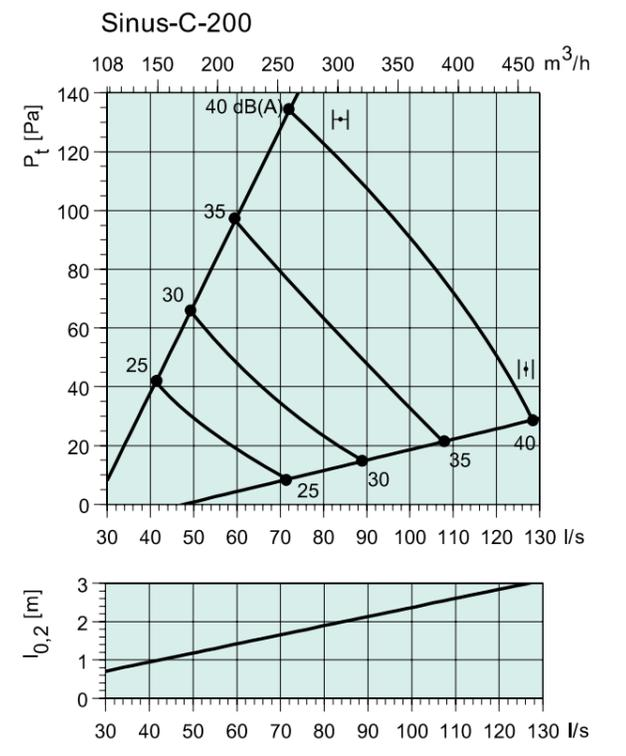
Боковой зазор открыт на 20мм
