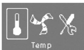
"Пустой" термометр на дисплее означает 6-е значение уставки, и в таком случае включается ручной летний режим работы. См. глава 8.3
