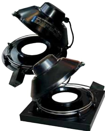
Крышные вентиляторы одностороннего всасывания TFSR/TFSK оснащены рабочим колесом с загнутыми назад лопатками и двигателями с внешним ротором. Электродвигатель можно откинуть наружу для удобства осмотра и технического обслуживания. Двигатель оснащен встроенным выключателем. В комплект поставки входит кабель электропитания длиной 1 м.
