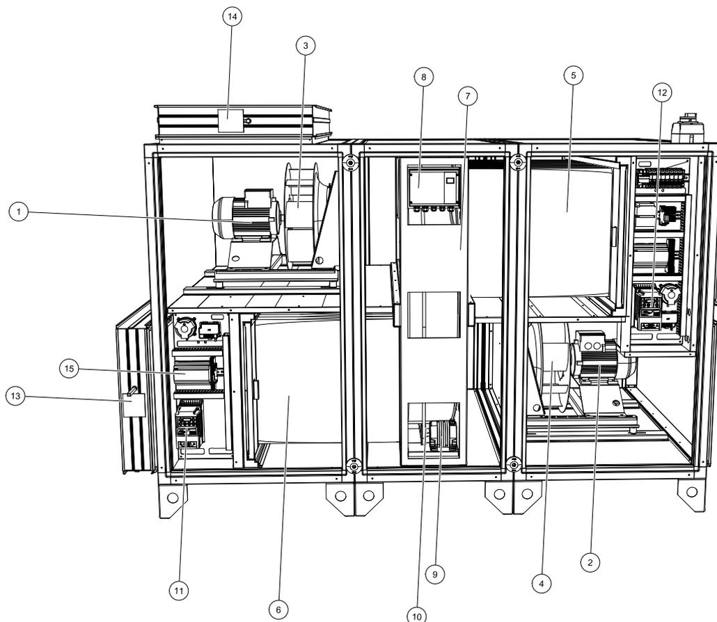
**Рис. 1 Компоненты агрегатов типа EL и HW**
