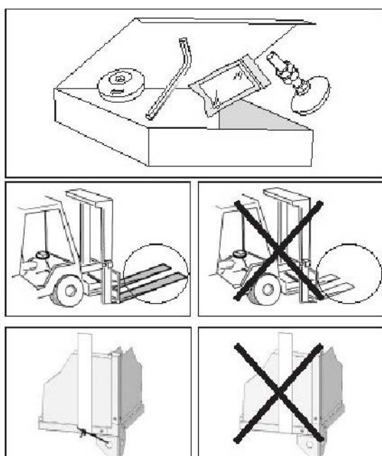
При подъеме с помощью вилочного погрузчика или домкрата для поддонов вилы погрузчика должны располагаться под днищем по всей его длине, в противном случае возможно повреждение днища. При использовании крана стропы необходимо крепить к опорам или поддону. Важно, чтобы стропы не соскользнули во время подъема.
