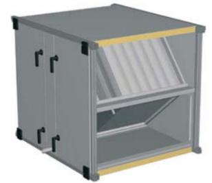
офисы и отели. Коррозионностойкие теплообменники со специальным покрытием алюминиевых пластин устанавливаются в помещениях с агрессивной воздушной средой. КПД утилизации регулируется с помощью встроенного байпаса.
