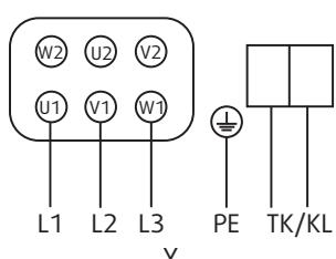
Anschluß für niedere Drehzahl
