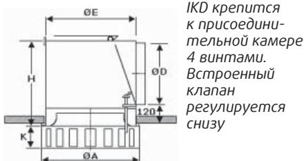
IKD крепится к присоединительной камере 4 винтами. Встроенный клапан регулируется снизу
