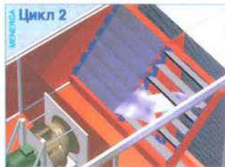
В первом цикле удаляемый воздух с помощью электроприводных клапанов направляется в аккумулятор 1 и нагревает его. Одновременно с этим наружный воздух проходит через аккумулятор 2, который был уже нагрет в предыдущем цикле.
