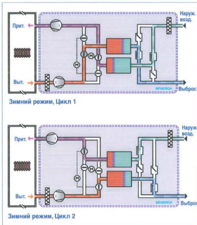
Во втором цикле наружный воздух будет нагреваться в аккумуляторе 1, а удаляемый воздух в этом цикле будет нагревать аккумулятор 2, охлаждённый в предыдущем цикле
