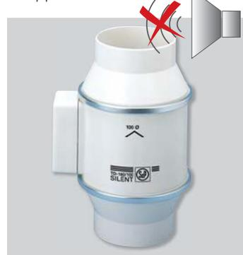
У моделі TD-160/100N SILENT електродвигун кріпиться до корпусу за допомогою гумових "сайлент-блоків", які запобігають передачі вібрації на корпус вентилятора. Така конструкція дозволяє досягти низького рівня шуму без застосування особливого звукоізолюючого корпусу.
