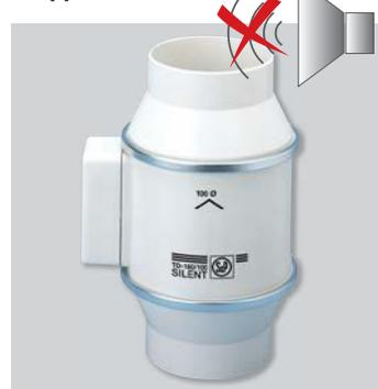
У модели TD-160/100N SILENT электродвигатель крепится к корпусу при помощи резиновых "сайлент-блоков", которые предотвращают передачу вибрации на корпус вентилятора. Такая конструкция позволяет достичь низкого уровня шума без применения особого звукоизолирующего корпуса.
