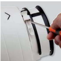
При помощи отвертки, ослабьте защелку.
