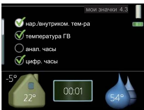
Можно выбирать значок, отображаемый при закрытой дверце F1245. Можно выбирать максимум 3 значка. При выборе большего количества исчезнут значки, выбранные ранее. Значки отображаются в порядке, выбранном пользователем.
