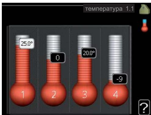
Если дом оборудован несколькими системами климат-контроля, это указано на дисплее в виде термометра для каждой системы.
