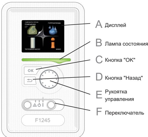
За дверцей теплового насоса имеется дисплей, используемый для связи с F1245. Здесь можно:
