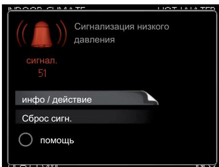
Аварийная сигнализация указывает на сбой того или иного типа, о чём свидетельствует состояние лампы, меняющей цвет с непрерывного зеленого на непрерывный красный. Кроме того, в информационном окне отображается сигнальный колокол.
