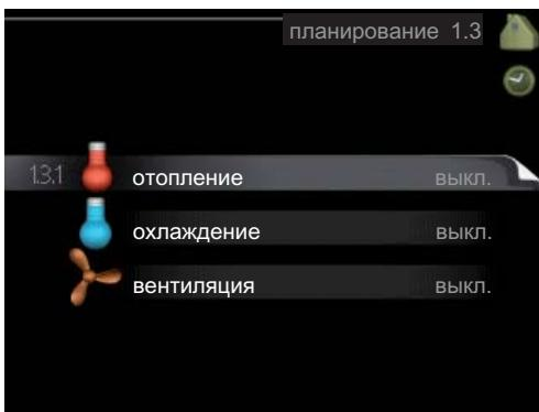
В меню **планирование** температура в помещении (отопление/охлаждение/вентиляция) планируется для каждого рабочего дня.
