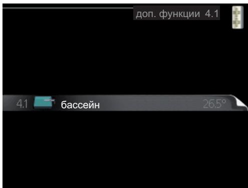
В подменю можно задать уставки для всех дополнительных функций, установленных в системе отопления.
