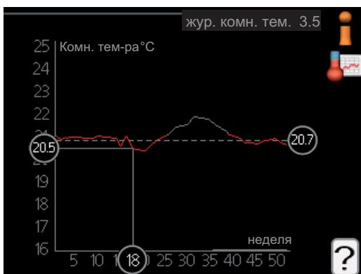
Здесь отображается средняя еженедельная температура в помещении на протяжении прошлого года. Пунктирная линия указывает на среднегодовую температуру.
