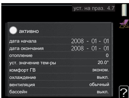
Для сокращения потребления энергии в течение праздников можно запланировать снижение температуры отопления и горячей воды. Работу охлаждения, вентиляции и бассейна также можно запланировать, если эти функции подключены.
