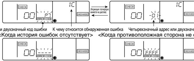
Четырехзначный или двухзначный код ошибки К чему относится обнаруженная ошибка Четырехзначный адрес или двухзначный номер адреса блока
