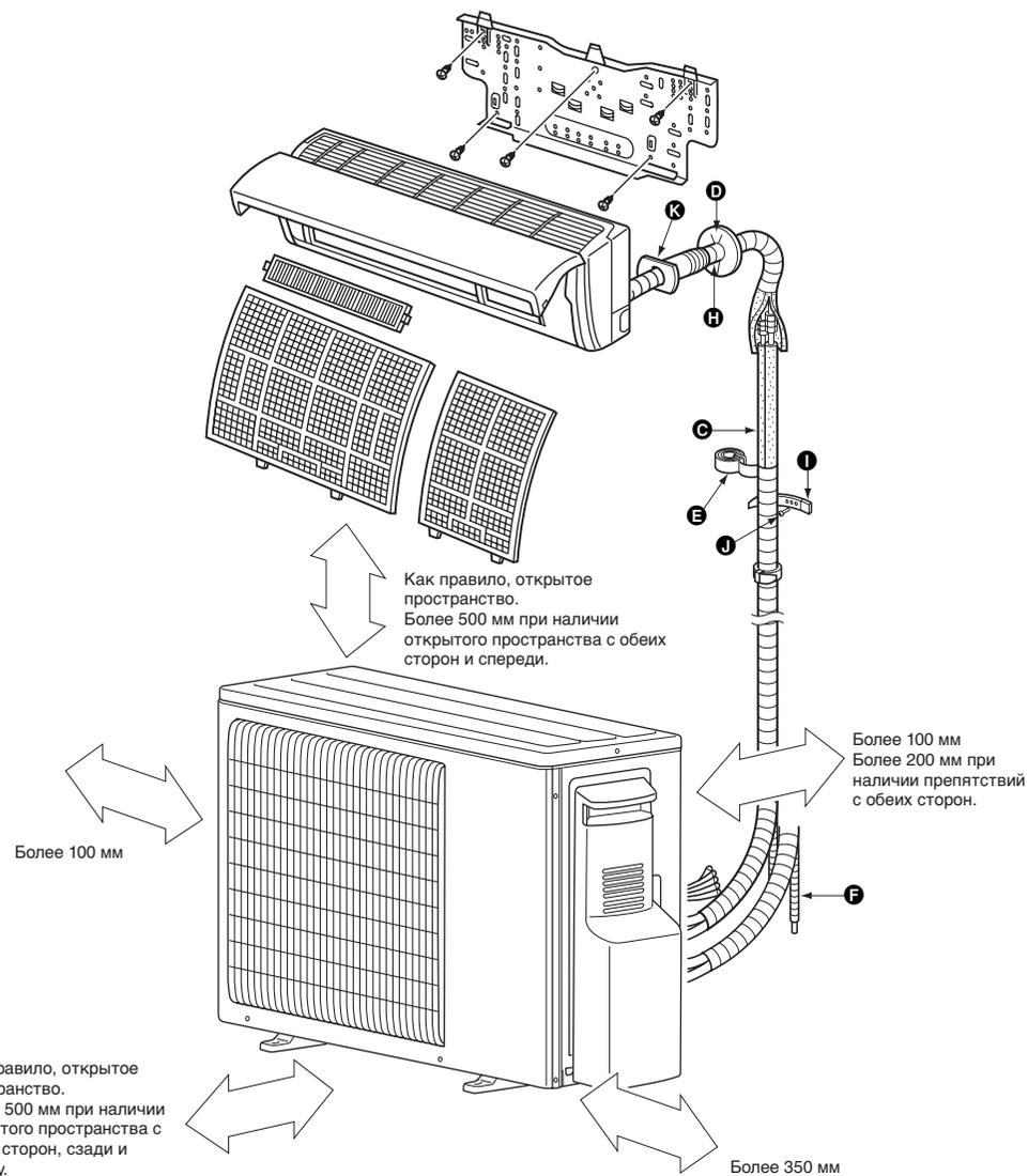
**Примечание:** Расстояния рядом со стрелками на рисунке выше требуются для обеспечения эффективной работы кондиционера. Устанавливайте кондиционер, по возможности, на открытом пространстве в целях облегчения в будущем работ по техобслуживанию и ремонту.
