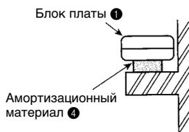
При монтаже блока платы ① в потолке или внутри стены необходимо оборудовать крышку люка в целях удобства последующего обслуживания.
