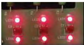
Рис. 2-11 Индикация LED при нормальном выходе инвертора.
