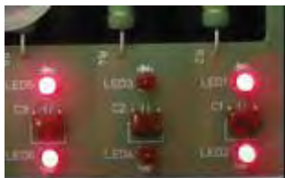
Рис. 2-12 Индикация LED при обрыве V фазы.
