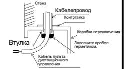
④ **Подключите кабель пульта дистанционного управления к клеммной колодке на нижней части корпуса**
