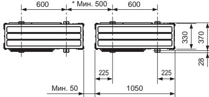
\* При установке одиночного наружного прибора зазор должен составлять не менее 15 мм.
