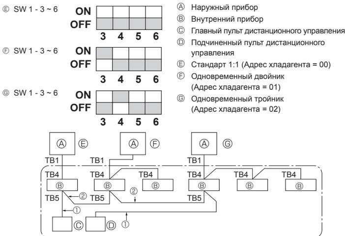
\* Установите адрес хладагента, используя ДИП-переключатель на наружном приборе.
