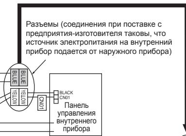
Если внутренний и наружный приборы имеют отдельные источники электропитания, измените соединения разъемов, как показано на следующем рисунке.
