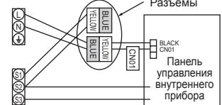
Отдельные источники электропитания для внутреннего прибора/наружного прибора
