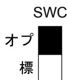
При использовании данной функции воздух выходит одновременно из верхнего и нижнего воздуховыпускных отверстий для обеспечения эффективного охлаждения или обогрева помещения. Данная функция устанавливается с помощью переключателя SWC на адресном щите.
