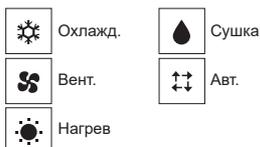
\* Режимы работы, которые недоступны для моделей подключенных внутренних блоков, не будут отображаться на экране.
