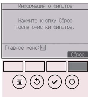
Для сброса значения фильтра нажмите кнопку **F4**. Сведения по очистке фильтра см. в технической документации к внутреннему блоку.
