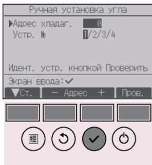
С помощью кнопки **[F1]** переместите курсор на «Адрес хладаг.» или «Устр. №» для выбора. Выберите адрес блока охлаждения и номер блока для блоков, чьи дефлекторы должны быть зафиксированы в неподвижном состоянии, с помощью кнопок **[F2]** или **[F3]**, затем нажмите кнопку **[ВЫБОР]**.
