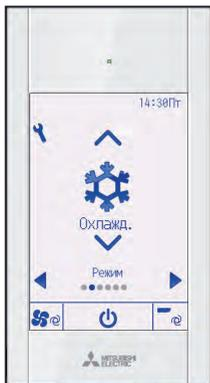
При каждом нажатии кнопки ▼ или ▲ осуществляется циклическая прокрутка следующих режимов работы. Выберите желаемый режим работы.
