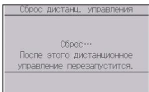
Контроллер дистанционного управления автоматически перезапустится после сброса параметров.
