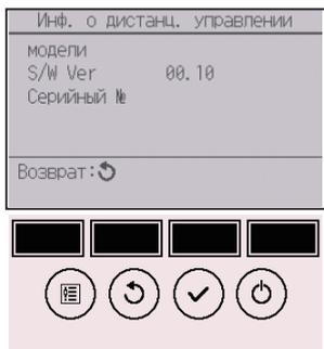
В итоге можно проверить модель, версию программного обеспечения и серийный номер контроллера дистанционного управления.
