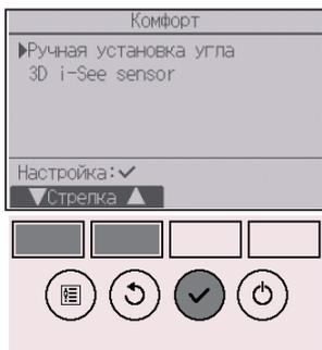
С помощью кнопки **[F1]** или **[F2]** выберите «Ручная установка угла», а затем нажмите кнопку **[ВЫБОР]**.
