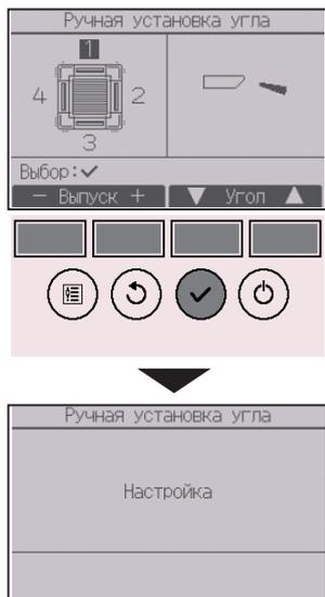
Отобразятся текущие настройки угла дефлектора.
