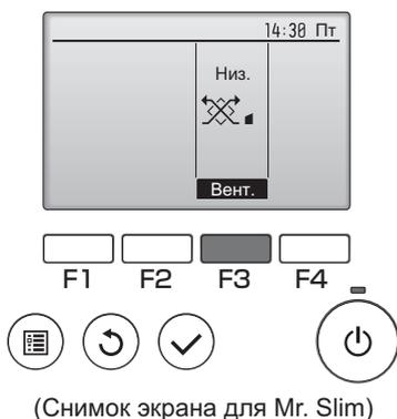
Нажмите кнопку **F3** для перехода между вариантами настройки вентиляции в следующем порядке: «Выкл», «Низ.» и «Выс.».
