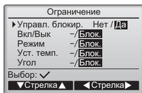
Отобразится окно, в котором можно настроить функцию блокировки управления.
