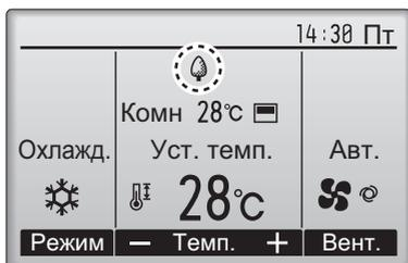
отобразится в главном окне в «полном» режиме отображения, когда блок работает в режиме энергосбережения.
