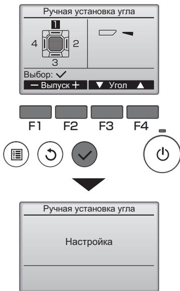
Отобразятся текущие настройки угла дефлектора.
