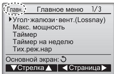
Следующие настройки не могут быть выполнены со вспомогательного контроллера. При необходимости, выполните эти настройки с основного контроллера. «Главн.» будет отображаться в заголовке главного меню на основном контроллере.
