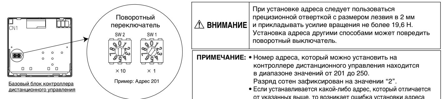
**ВНИМАНИЕ** При установке адреса следует пользоваться прессионной отверткой с размером лезвия в 2 мм и прикладывать усилие вращения не более 19,6 Н. Установка адреса другими способами может повредить поворотный выключатель.
