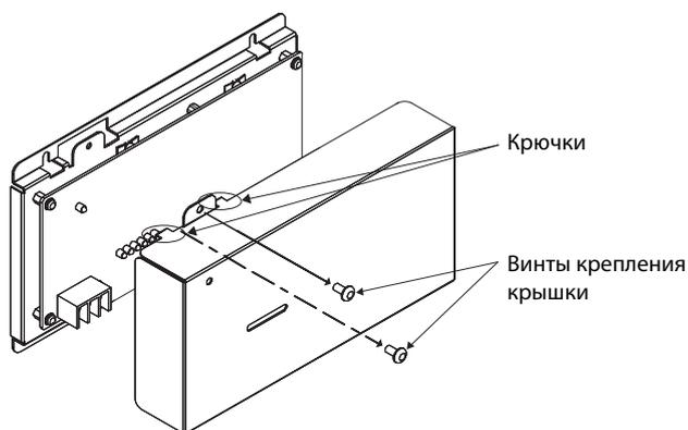
**Примечание.** Два крючка расположены в верхней части крышки.
