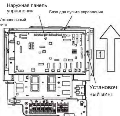
**1** Удалите два винта, которые крепят основание платы управления коробки электрических компонентов, а затем сдвиньте основание в направлении стрелки, чтобы снять его с коробки электрических деталей.
