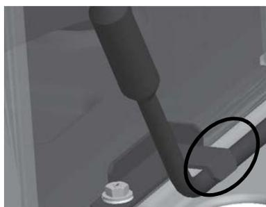
Примечание) Правильно закрепите нагревательное устройство основания и монтажный кронштейн.
