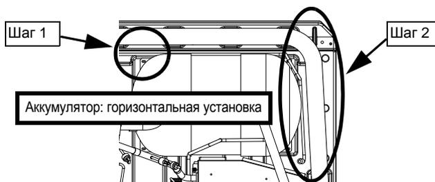
Шаг 1. Установите монтажные кронштейны нагревательного устройства ⑩ и ⑪ или ④.
