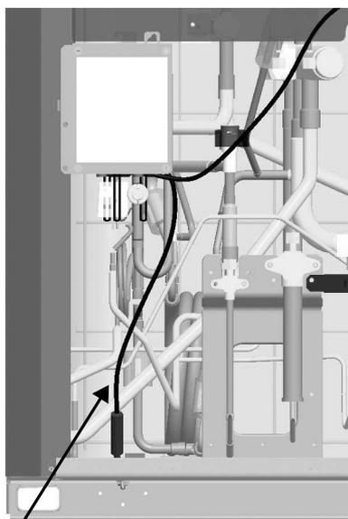
Нагревательное устройство основания (проводка слева)
