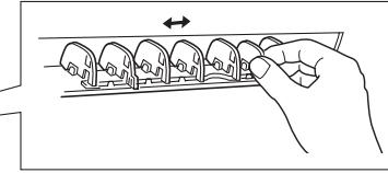
Отрегулируйте вертикальную заслонку, передвигая фиксаторы второй заслонки с обоих концов вертикальной заслонки в сторону предпочтительного направления воздушного потока.
