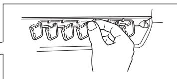
Отрегулируйте вертикальную заслонку, передвигая фиксатор в направлении, противоположном предпочтительному направлению воздушного потока.
