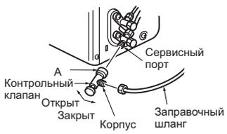
Если при креплении контрольного клапана к сервисному порту прилагать чрезмерное давление, сердечник клапана может деформироваться или открутиться. Это может привести к утечке газа.
