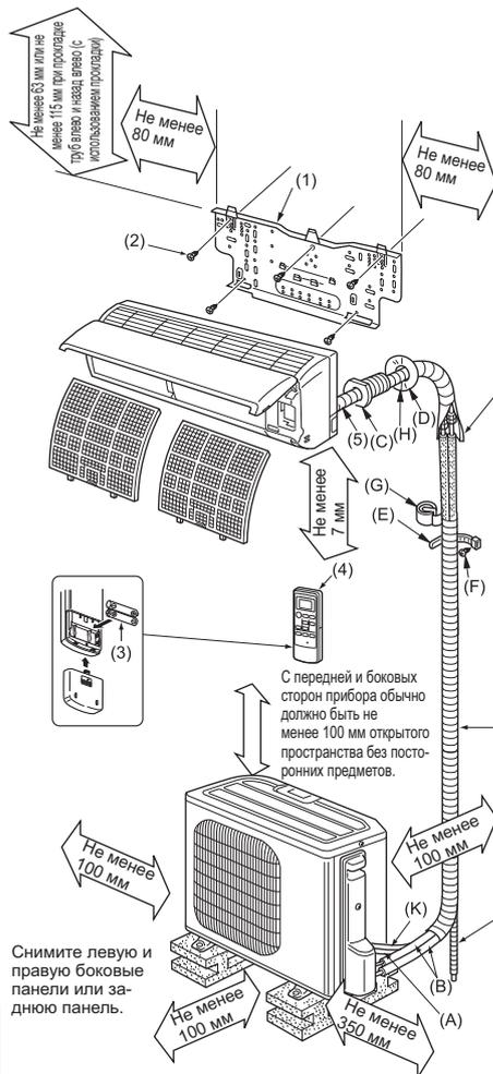
Обязательно используйте втулку для стенового отверстия (C) в целях предотвращения контакта соединительного провода (A) внутреннего/наружного прибора с металлическими деталями стенового перекрытия, а также для предотвращения повреждения проводов крысами, если стена полая.
