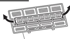
Потяните, чтобы снять с воздушного фильтра
