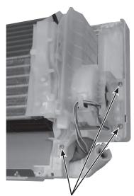
Screws of the fan motor
