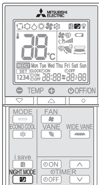
Режим NIGHT mode (нічний режим) змінює яскравість індикатора режиму роботи, вимикає звуковий сигнал і обмежує рівень шуму зовнішнього блока.
