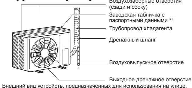
Внешний вид устройств, предназначенных для использования на улице, может отличаться.
