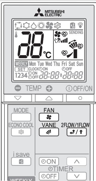
Нажмите **VANE**, чтобы выбрать скорость вентилятора. При каждом нажатии скорость вентилятора изменяется в следующем порядке:
