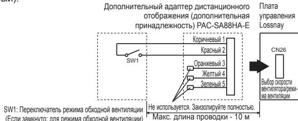
Если переключатель SW1 находится в положении «ВКЛ», режим вентиляции блока Lossnay переключается на режим обходной вентиляции независимо от настроек на контроллере дистанционного управления.
