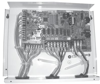
Контроллер РАС-IF041В-Е предназначен для управления тепловыми насосами «воздух-вода» полупромышленной серии Mr. Slim, а также исполнительными устройствами контура теплоносителя: циркуляционным насосом, 3-ходовым клапаном, двухсекционным электродкотлом, электронагревателем бойлера.
